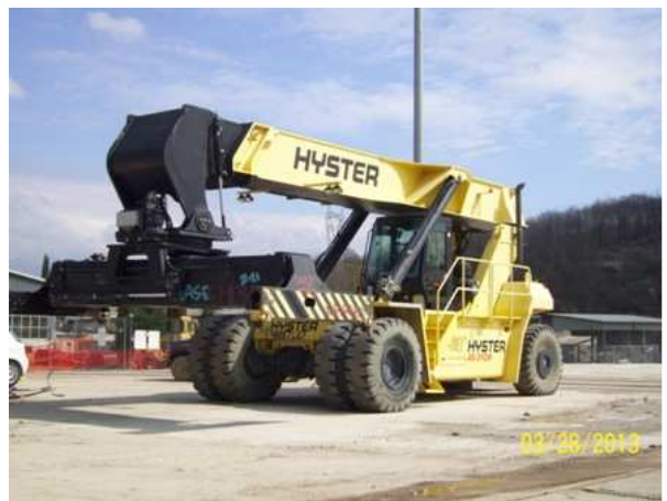
Gru per la movimentazione dei container
